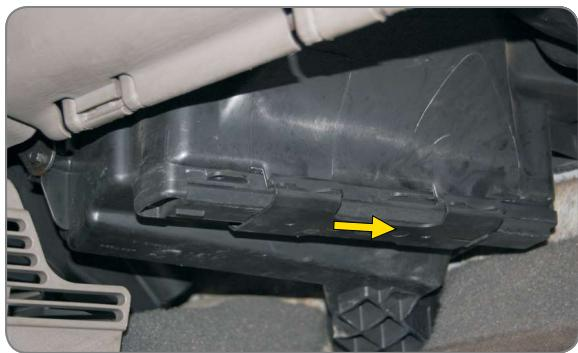
**PL** Usunąć blokadę filtra, wyjąć zużyty filtr, zamontować nowy, wykonać wszystkie powyższe czynności w kolejności odwrotnej
