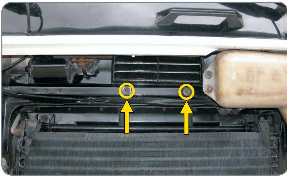
PL Odkręcić wkręty pokrywy filtra, usunąć pokrywę
