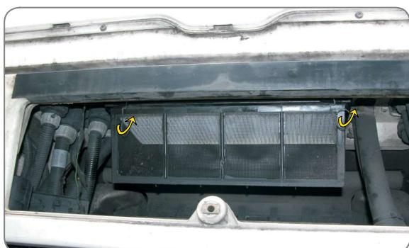
**PL** Odpiąć klipsy zabezpieczające, wyciągnąć gniazdo filtra
