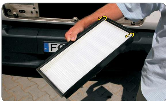
**PL** Usunąć filtr z gniazda, zamontować nowy, wykonać powyższe czynności w kolejności odwrotnej
