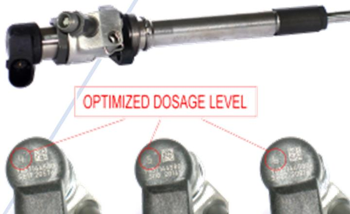
I numeri cerchiati in rosso identificano il grado di ottimale di dosaggio carburante. Differenti valori possono provocare scompensi ed irregolarità nel funzionamento motore e nella gestione dei gas di scarico.
